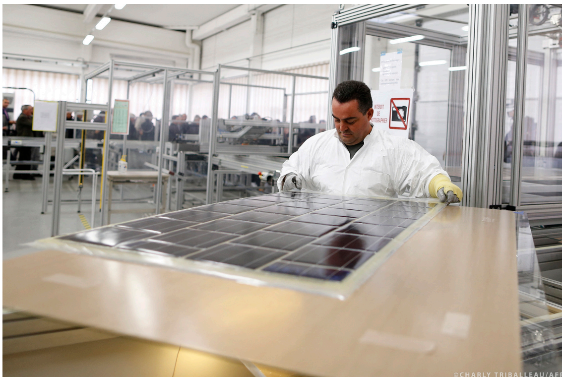
Κατασκευή φωτοβολταϊκών πánελ για τη δημιουργία του πρώτου ηλιακού δρόμου ©CHARLY TRIBALLEAU / AFP
